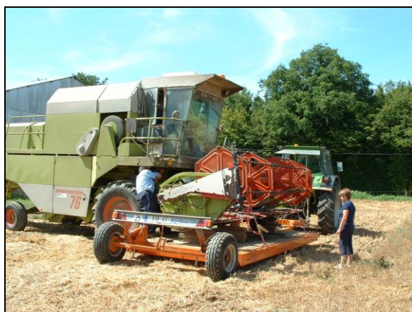
La « coupe » de la moissonneuse est déposée sur sa plate-forme en vue de son transport à 30 km de Villechauve.
